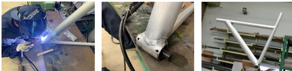
図 9 トップチューブ (A) とダウンチューブ (B) の溶接作業
