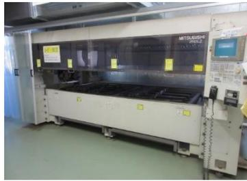
図2. レーザー加工機 (切断用)
