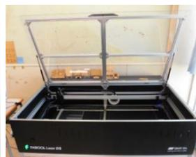
図8. レーザー加工機 (刻印用)
