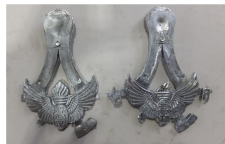
図5 できた製品(右側が不良品)
