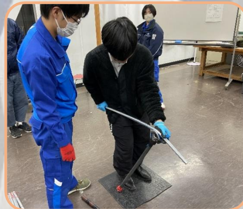
【金属管加工】:パイプベンダでリズムよく曲げます
