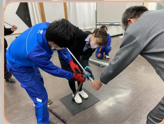
【金属管加工】:パイプベンダでリズムよく曲げます
