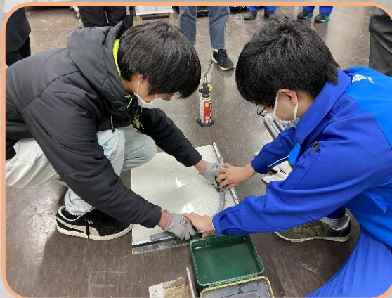
【樹脂管加工】:熱を加え樹脂管を柔らかくし曲げます
