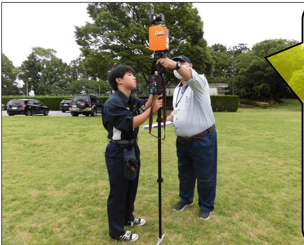
オレンジ色の器械の上部からレーザーが出て、木の高さや太さ、本数を短時間で計測することができます。
