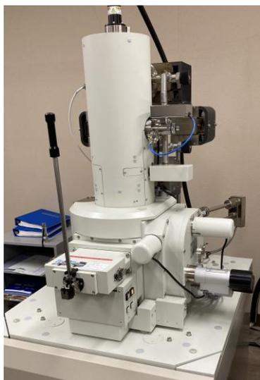
図11. 電界放出型走査電子顕微鏡 JSM-6701F
