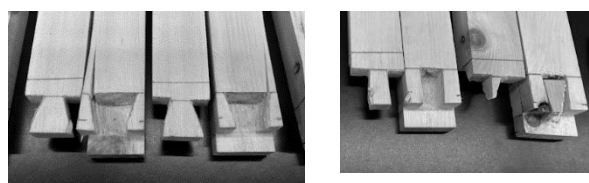
▲蟻ほぞの脚の傾きが20°の柱が折れた様子(左)と5°の柱が折れた様子(右)
