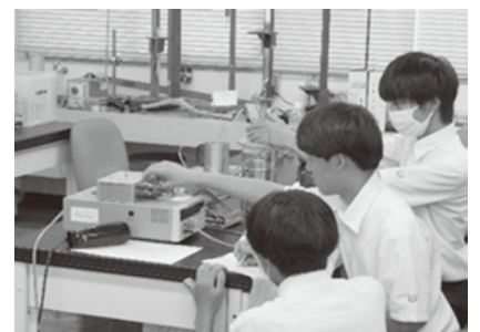
温度を下げて超伝導を確認する実験
