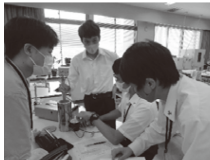
温度を下げ電気抵抗を測る実験
