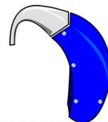
春休み中に、補聴器のイヤモールドの欠損等はないか、チューブが固くなっていないか、フックの緩みはないか、マイクカバーの交換（3か月に一度くらいの頻度で）、補聴器カバーの洗濯や交換、乾燥剤の確認等のお手入れをしましょう。
