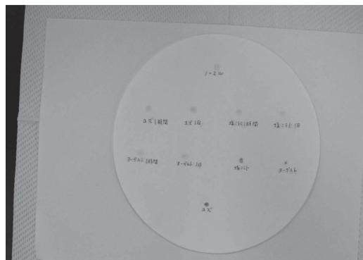
煮汁を一定量(5μL)ろ紙に浸み込ませ、ニンヒドリンというアミノ酸を染色する試薬を噴霧した。アミノ酸が存在すると、藍～青色に染まる。
